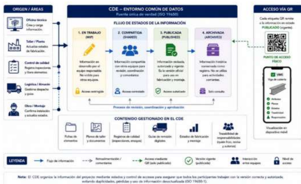
Figura 3. Estructura interna del entorno común de datos: estados de la información según la ISO 19650, contenido gestionado y punto de acceso físico de las etiquetas QR.
